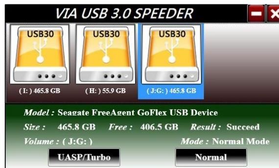
4. Das USB-Speichergerät, das "**UASP**" anzeigt, arbeitet im UASP-Modus
